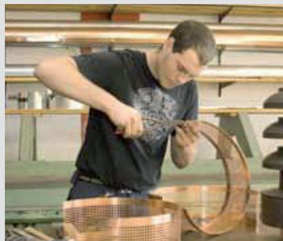
**Bearbeitung eines Lüftungsblechs** Das Lüftungsblech wird in der Werkstatt vorbereitet und anschliessend am Dachfuss fertig montiert.
