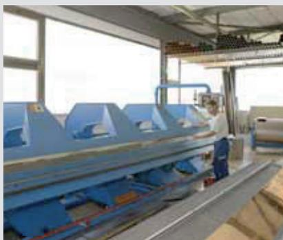
**Abbiegen von Blechen mit Maschine** Auf Abbiegemaschinen werden die Bleche in die nötige Form gebogen (teilweise computergesteuert). Die Berufsleute können diese Maschinen bedienen.
