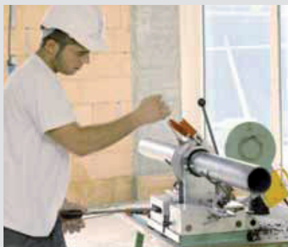
Arbeit an der Werkbank An der Werkbank fertigen die Sanitärinstallateurinnen und -installateure spezielle Rohrverbindungen an. Im Bild die Arbeit am Schweissspiegel.
